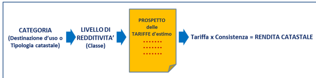
Figura 1.2: Procedimento di determinazione della rendita catastale per le unità immobiliari a destinazione ordinaria (categorie dei Gruppi A, B e C)
